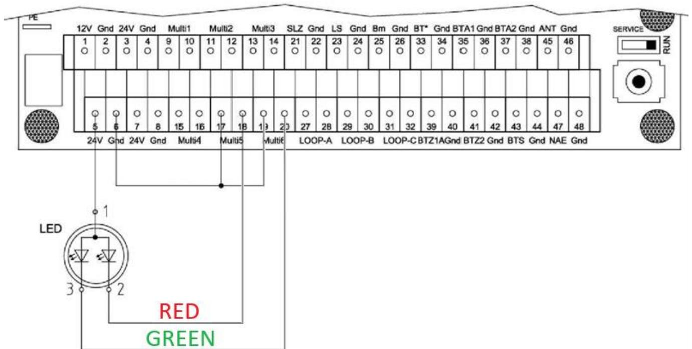
La prochaine instruction explique le raccordement de la bande LED. La bande LED peut être contrôlée par l'un des 6 relais multifonctionnels (MULTI1 – MULTI6)
