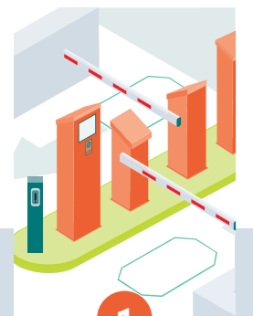
1 PARKING SLAGBOMEN MET ANPR EN BEDIENINGSZUILEN MET INFO-DISPLAY EN INTERCOM
